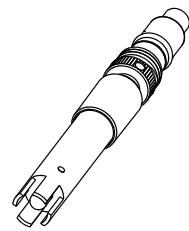
El sensor combinado pH/redox **HI 769828-1** incorpora una membrana de vidrio sensible al pH, un sensor de platino para medir el redox y una referencia de plata/cloruro de plata con unión doble con solución electrolítica en gel.
