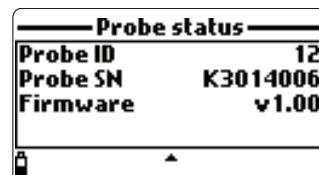
**Nota** Si en algún momento cambia el estado del sensor de la sonda, se mostrará automáticamente el display de estado de la sonda. Si esto ocurre, se habilitarán las teclas programables "Measurement Screen" y "Parameter Selection" (ver apartado 5.2).
