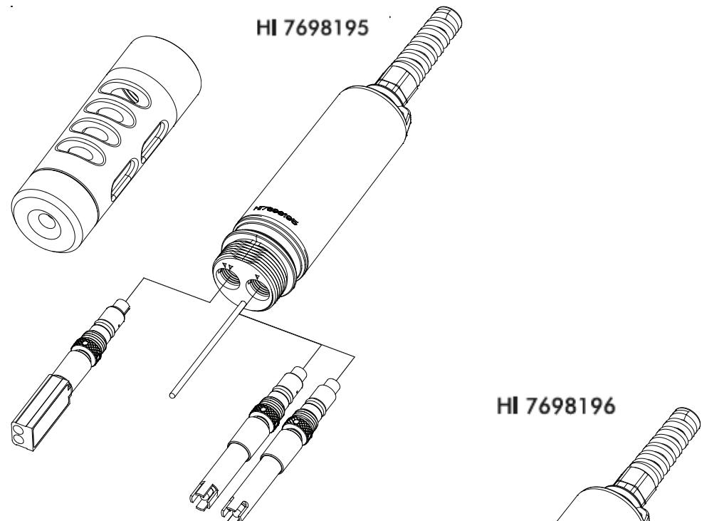
La sonda HI 7698196 admite dos sensores distintos:
