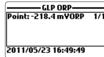
**Notas** Si no se realizó ninguna calibración de redox o se borraron con la opción "Restore factory calib.", se restaurarán los valores de desplazamiento y pendiente predeterminados y se mostrará el mensaje "Factory calibration". Pulse **ESC** para volver a la pantalla anterior.
